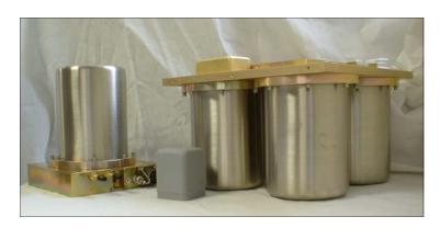
OTC设计并组建许多不同电离室,不同规格与结构,每一款根据具体目的进行了优化,OTC电离室不仅用于室内空气监测,还可用于手套箱,工艺管道,和气相色谱,及具有挑战性的环境,如核电站。OTC电离室满程灵敏度,从10<sup>-7</sup> Ci/m³到纯氚。可以被选择性的用于测量氚,或其氧化物,即使在其他辐射气体出现的情况下。OTC电离室设计容易组装和维护。
