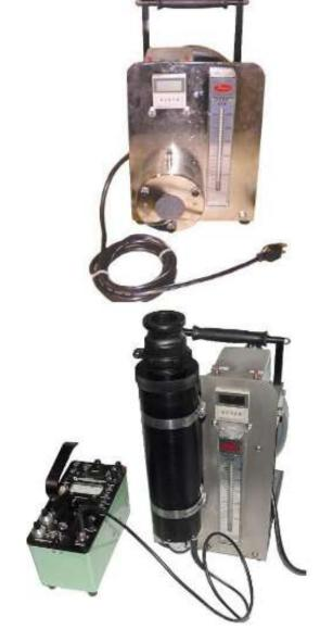
FR 系列空气监测器通过持续检测气溶胶辐射污染物和可选购的记录功能,以确保安全。此系统综合曝辐信息,敏感、多用途,尽管为工厂车间和医院呼吸测量系统设计,还可以用于监测通风柜和烟囱道排放物,达到 EPA 标准
